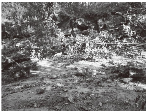
图 4 滑坡后缘及滑面软弱夹层
