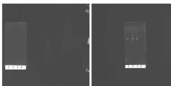
(a) 展开剂: 甲苯: 甲醇: 乙酸 (15: 5: 1) (b) 展开剂: 正丁醇: 乙酸: 水: 氯仿 (6: 2: 2: 1)
