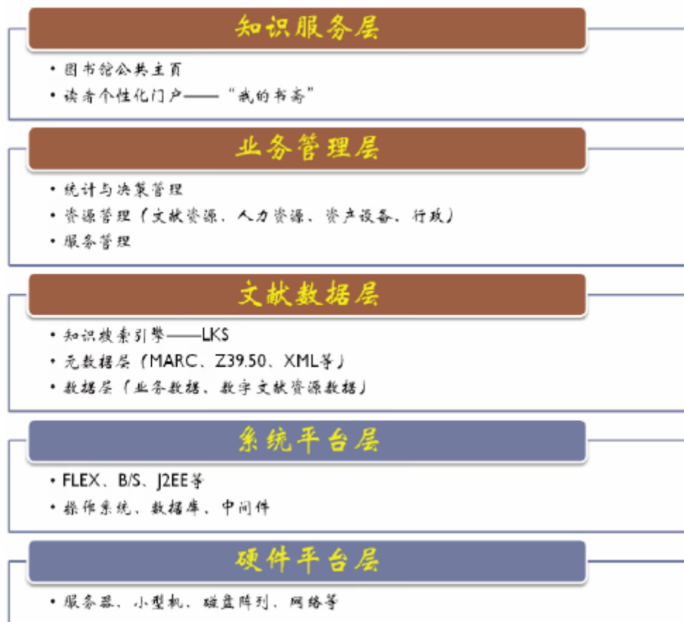
图 1 基于 J2EE 的图书馆 2.0 系统的五层架构体系
